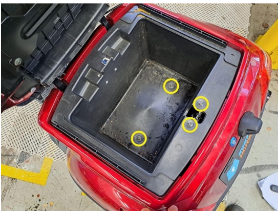
Irrota säilytyslokeron kiinnityspultit. (hylsy 8 mm).
