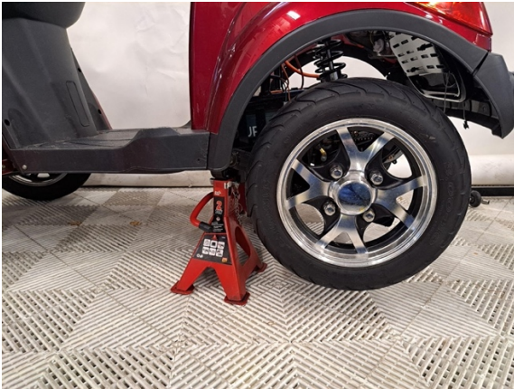
Nosta laitteen takaosa korokkeelle.
